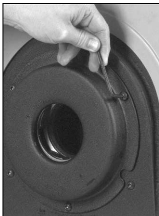
Figure 12A – Retrait de carter arrière du mandrin
