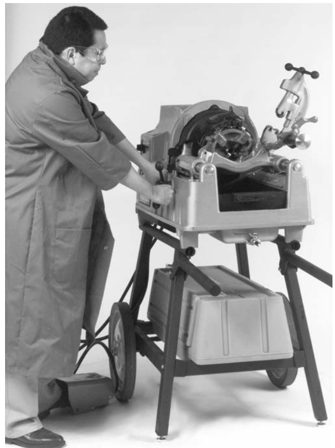
Figura 7 – Roscado con la Roscadora Automática No. 535
