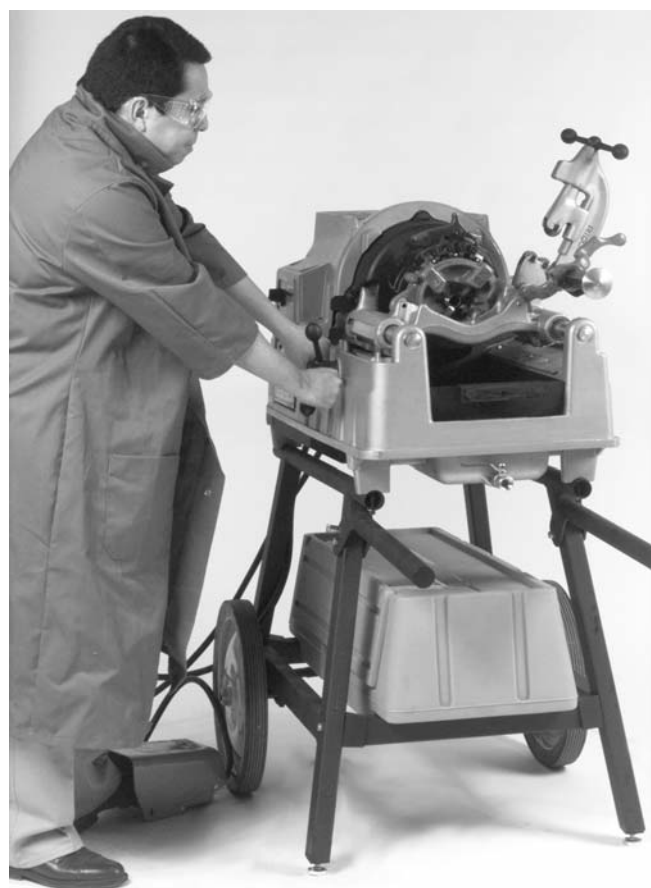
Figure 7 – Filetage des tuyaux avec la machine à fileter automatique Modèle 535
