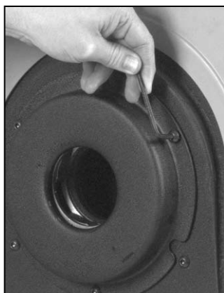
Figura 12A – Extracción de la tapa del mandril posterior
