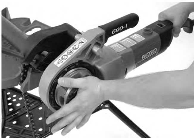
Figura 13 – Inicio del roscado
