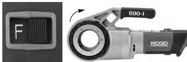
Figure 6A – Inverseur en position « F » (marche avant) pour rotation en sens horaire
