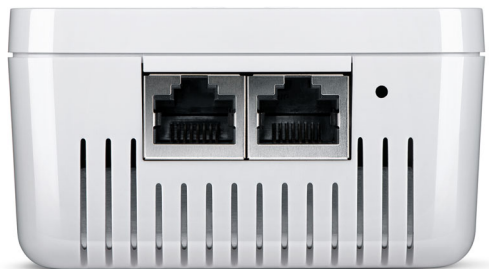
Fig. 3 Conexiones de red
