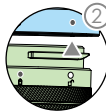
將雲台相機上的白點與 DGC2.0 接頭紅點對齊，並嵌入安裝位置。
